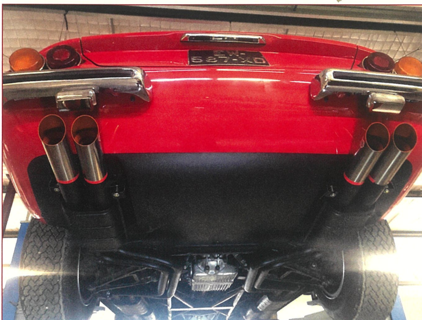
Impianto di scarico Exhaust silencers and outlets
