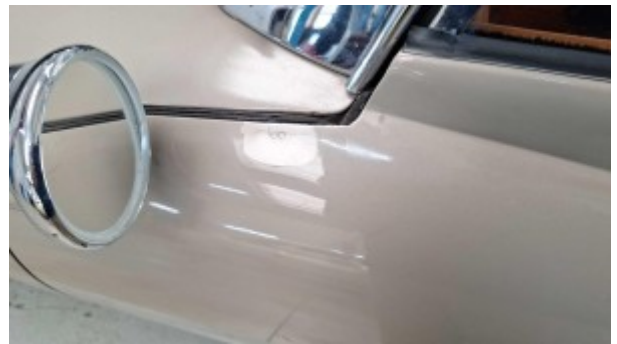
Défaut de peinture porte AVG
