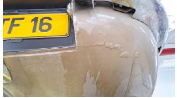
Corrosion jupe arrière
